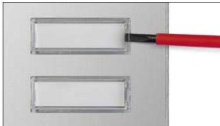
Beschriftungsfeld vorsichtig mit Hilfe eines Schraubendrehers aus der Türstation hebeln.
