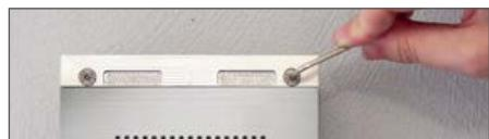
**3** Raccorder la station de porte et la fixer dans le boîtier en saillie/encastré prévu à cet effet, dans la paroi creuse ou dans la colonne du boîtier (série 5 uniquement). Pour les appareils de la série 10, fixer de nouveau les bandes en acier inoxydable.
