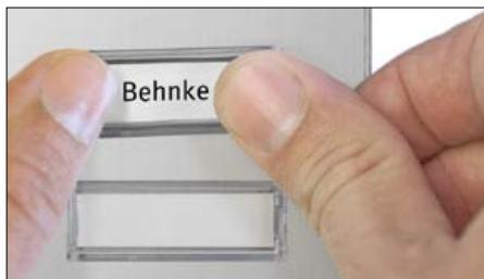
Beschriftungsfeld in die Öffnung der Türstation eindrücken – fertig.
